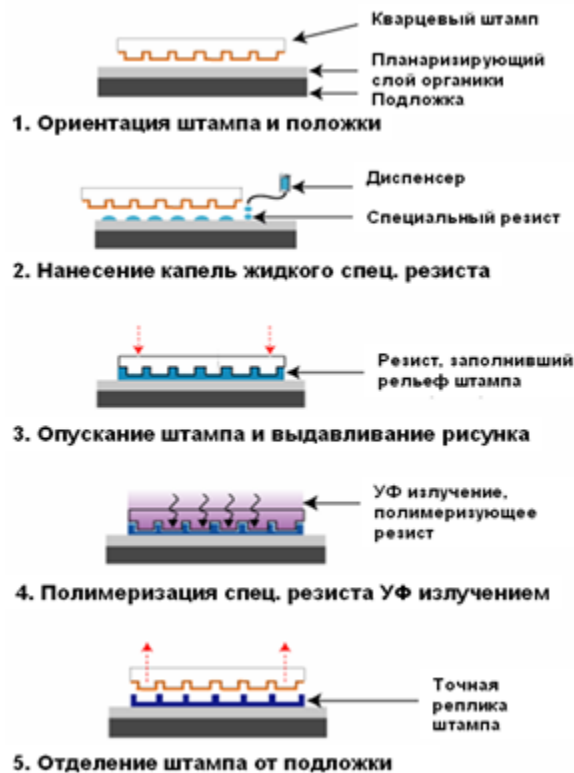
Рисунок 2.7 – Типовая последовательность технологических операций, выполняемых при литографии методом импринтинга
