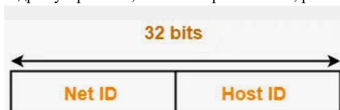
Рис. 1 Сетевая и хостовая части IP-адреса
