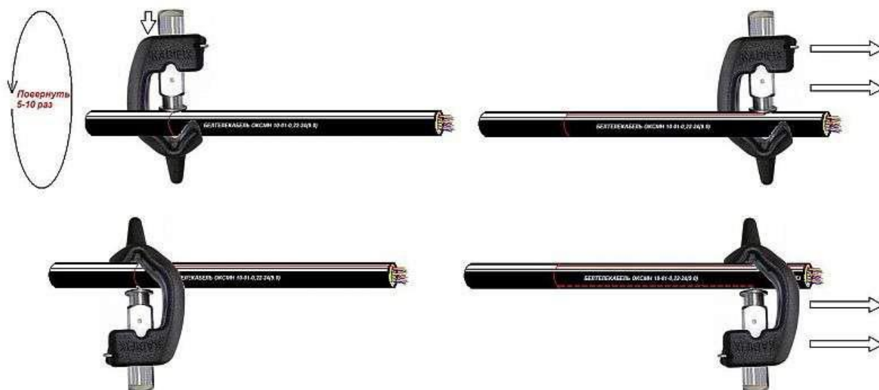
Рисунок 3.3.1 – Снятие внешней оболочки кабеля ножом-стриппером
