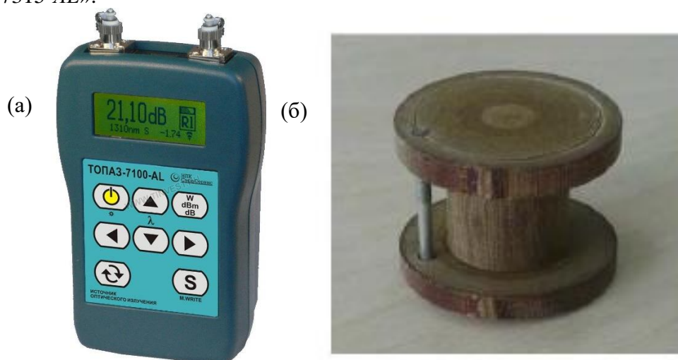
Рисунок 2.2.4 – Оптический тестер «Топаз-7315-AL» (а) и модовый скремблер (б)
