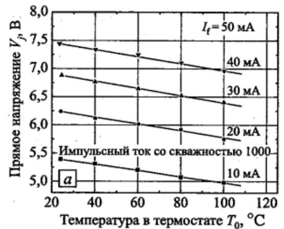
Рис. 3.3. Вольт-амперные характеристики светодиодов на основе InGaIn/AlGaIn/GaN при различных температурах окружающей среды. На вставке — участки характеристики до 10 мА; Зависимость прямого напряжения от температуры в термостате, полученная для светодиода УФ-диапазона AlGaIn в импульсном режиме со скважностью 1000 (б)
