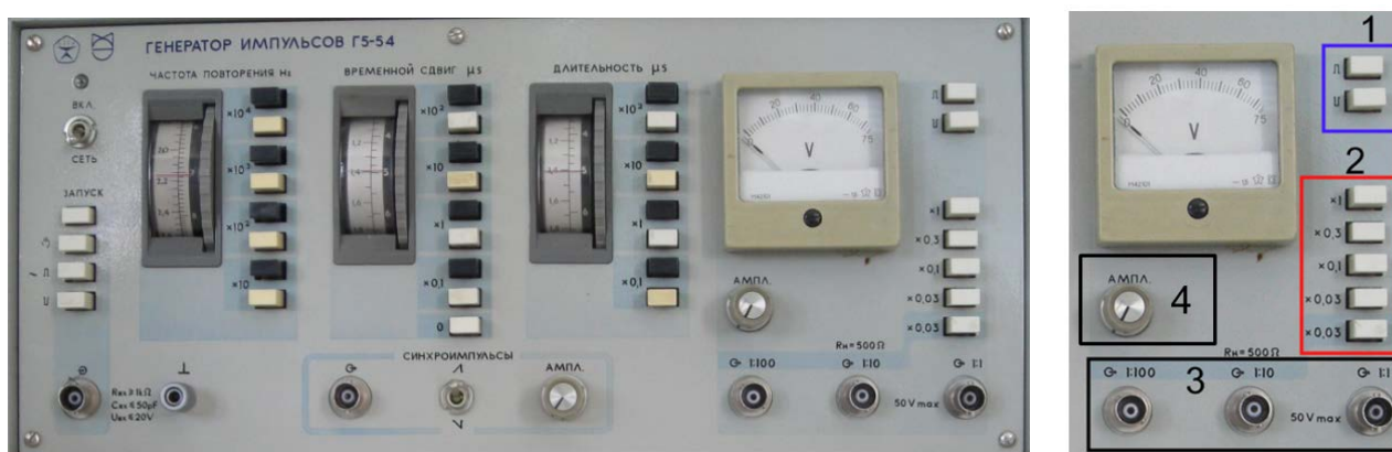
Рисунок 1.4 – Лицевая панель генератора прямоугольных импульсов Г5-54
