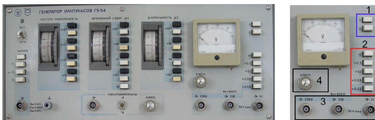
Рисунок 1.4 – Лицевая панель генератора прямоугольных импульсов Г5-54
