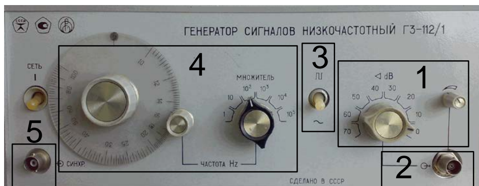
Рисунок 1.3 – Лицевая панель генератора сигналов низкочастотного ГЗ-112/1
