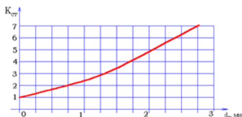
Рисунок 1.13 – График зависимости величины K_{ст} от расстояния между шайбами трансформатора сопротивлений
