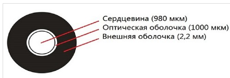
Рисунок 2.1 – Структура пластикового оптического волокна
