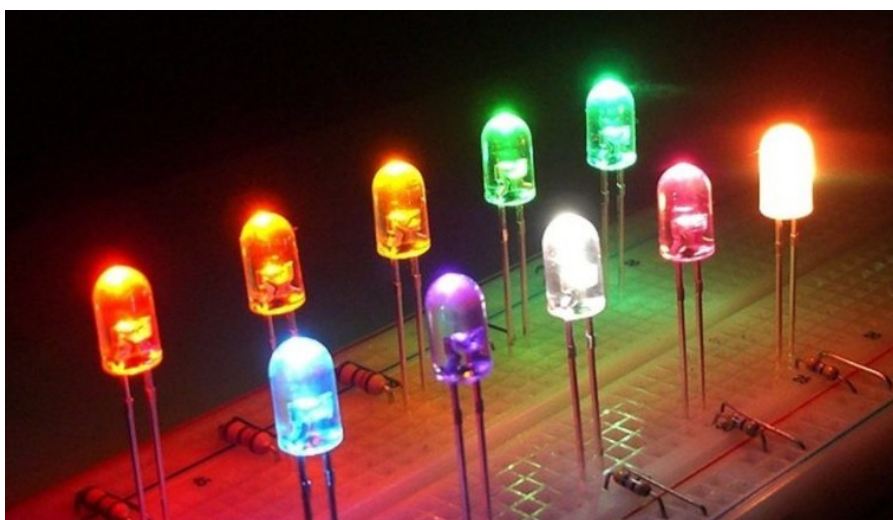
Рисунок 2.5 – Светодиоды разного спектра излучения
