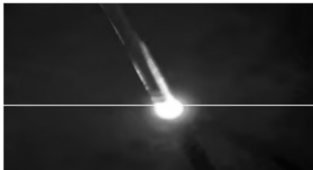
Рисунок 2.14 – График интенсивности по центру сечения изображения
