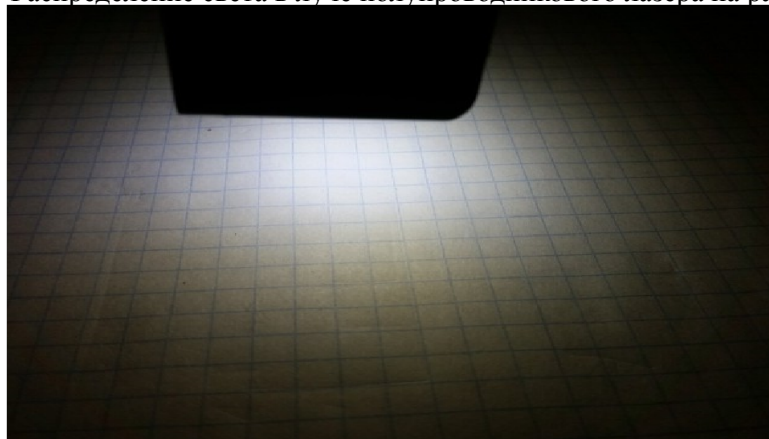
Рисунок 2.9 – Распределение света в луче белого светодиода на расстоянии 5 см
