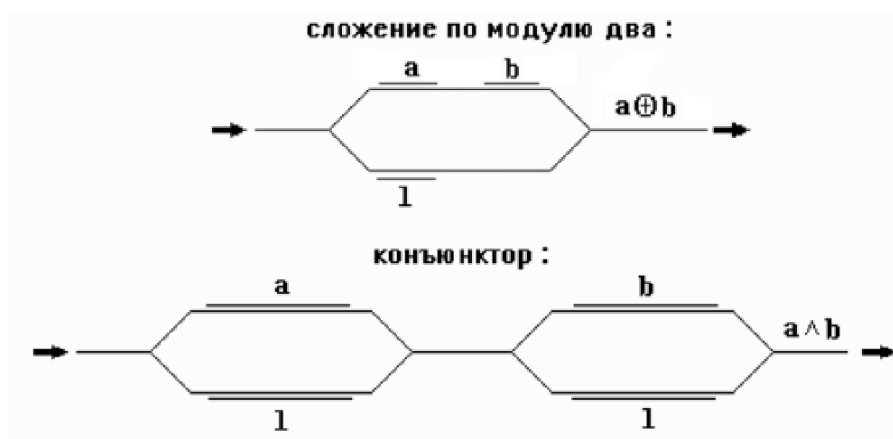
Рисунок 9.2 – Реализация сложных логических функций
