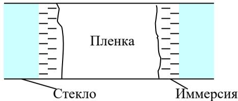
Рисунок 9.2 – Жидкостный компенсатор
