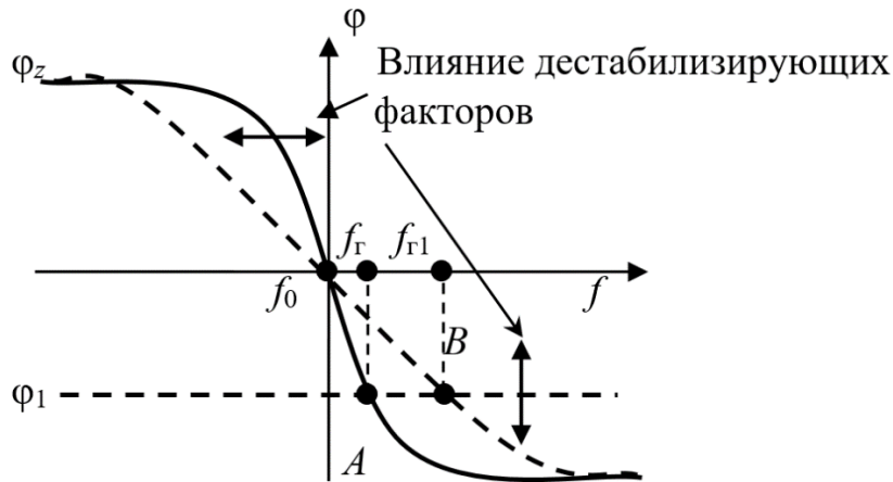
Рис. 14.6 – Пояснение механизма возникновения нестабильности частоты в автогенераторе с помощью фазовой характеристики
