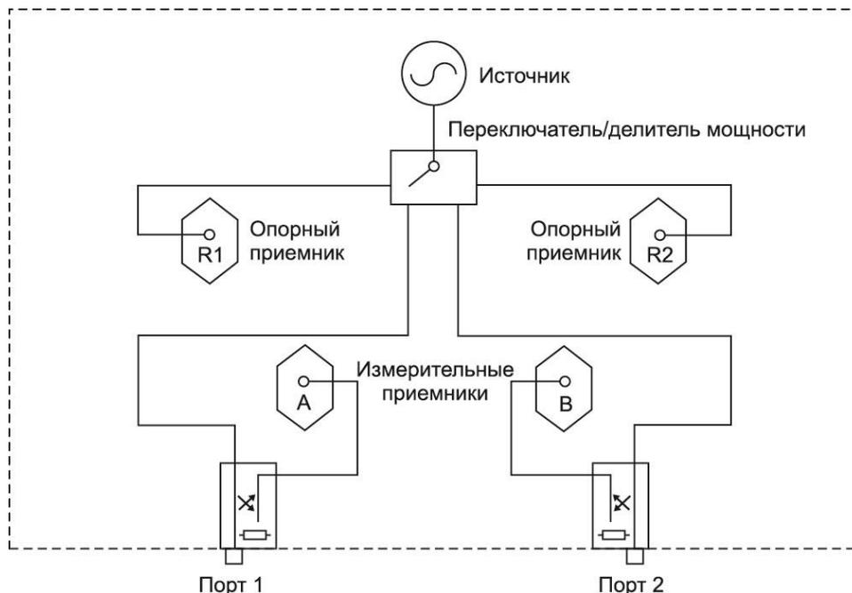
Рисунок 1.1 – Функциональная схема двухпортового векторного анализатора цепей
