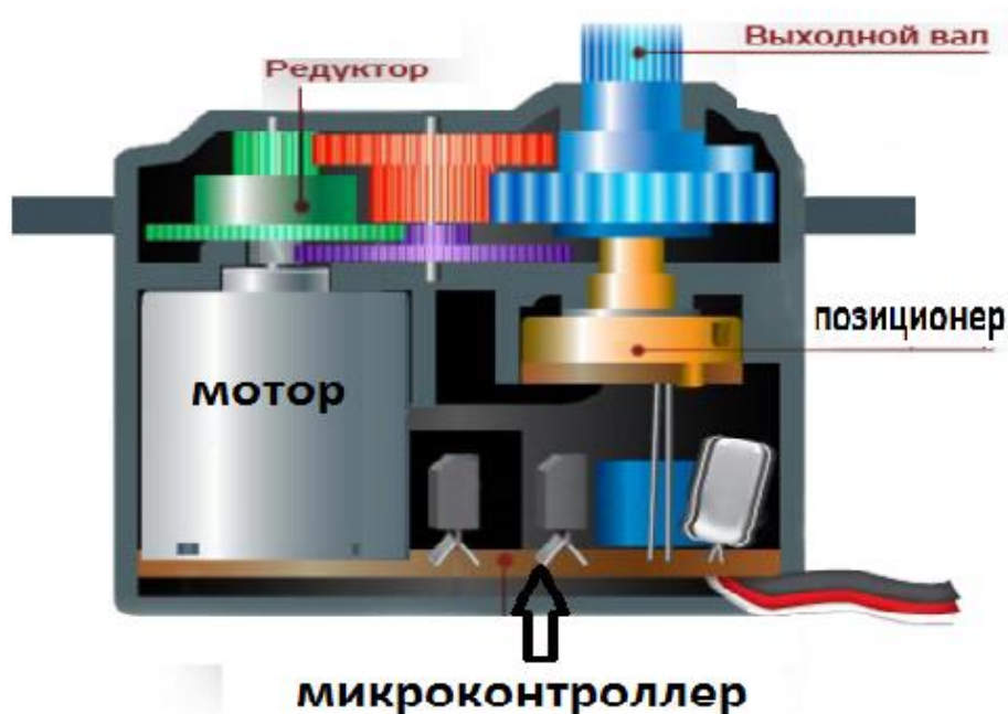
Рис. 17 – Структура сервопривода с редуктором
