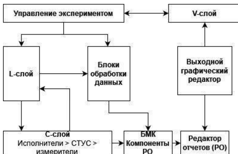
Рис. 27– Функциональная схема выходного редактора
