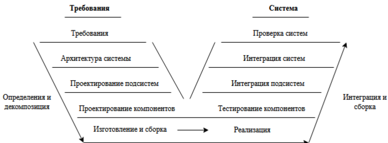
Рис. 12 – Этапы жизненного цикла системной инженерии на V-модели
