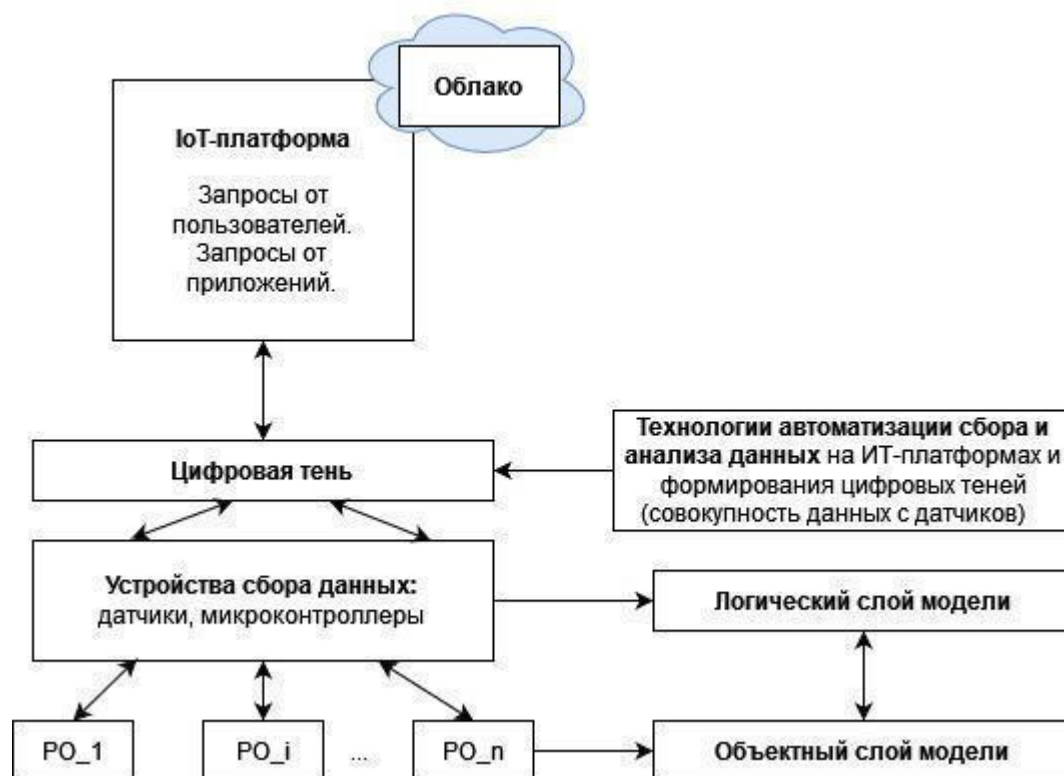
Рис. 20 – Структура данных на базе платформы IoT
