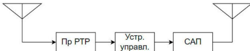
Рисунок 3.23 – Структурная схема станции ответных шумовых помех, прицельных по углу
