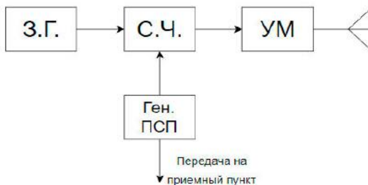
Рисунок 4.11 – Структурная схема системы с ППРЧ
