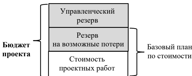
Рисунок 2.14 – Структура бюджета проекта с учетом управленческих резервов и резервов на возможные потери согласно PMBOK® Guide
