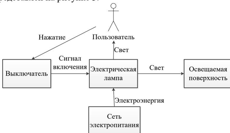
Рисунок 2 – Пример классической функциональной схемы
