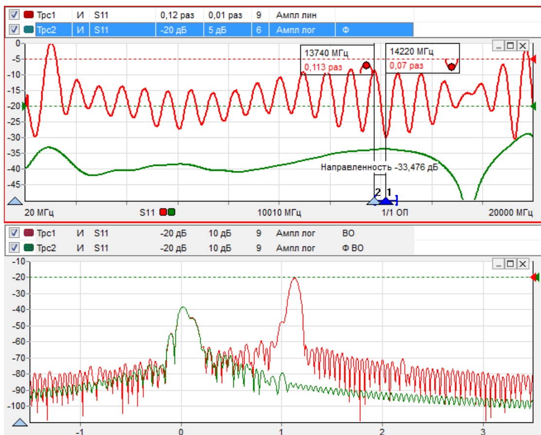
Рисунок 3.3 – Результаты измерения эффективной направленности |E_D^{eff}|
