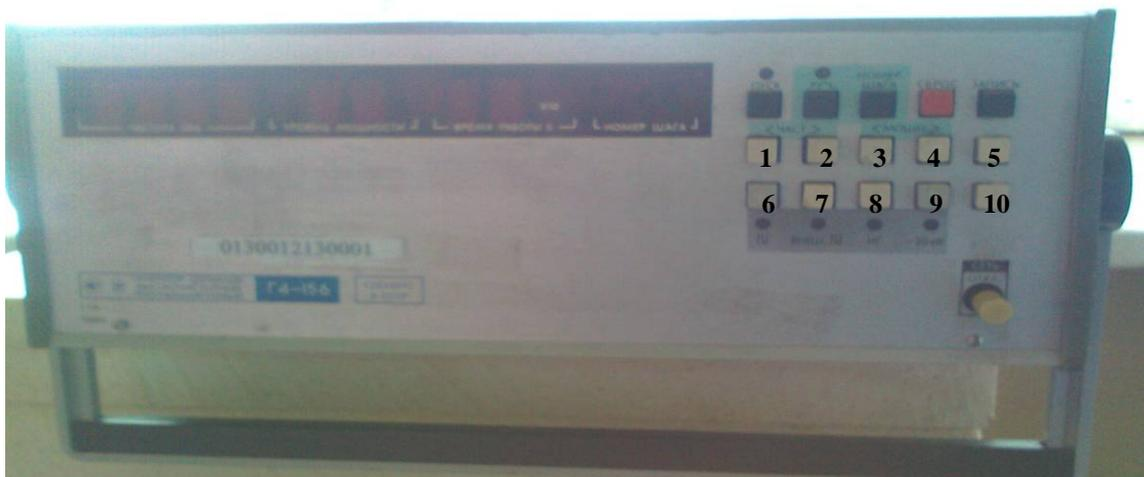
Рис.13. Внешний вид генератора сигналов Г4-156
