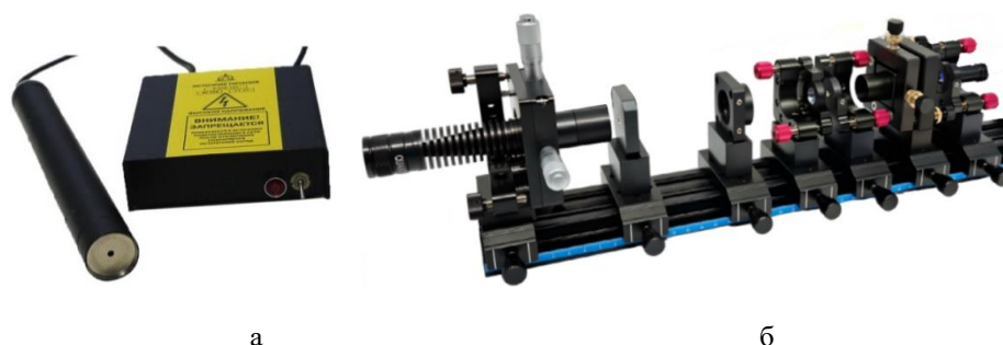
Рисунок 2.1 – Источники лазерного излучения: а – He-Ne лазер; б – YAG:Nd 3+ лазер с генерацией второй гармоники ( \lambda = 532 нм)
