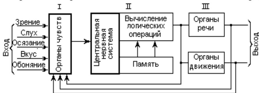
Рис.2 - Эквивалентная схема сложной системы «человек-оператор».
