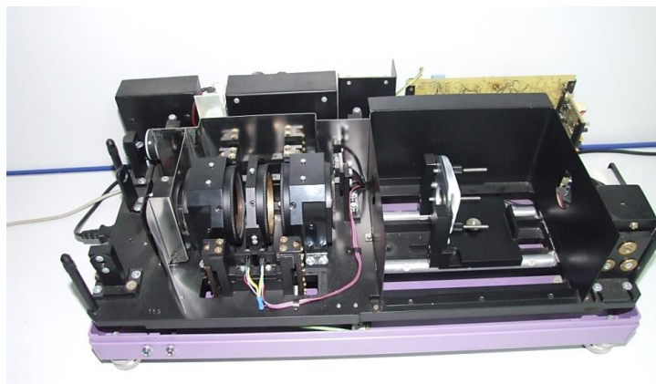
Рисунок 4.4 – Внутреннее устройство Фурье-спектрометра Инфралюм ФТ-801
