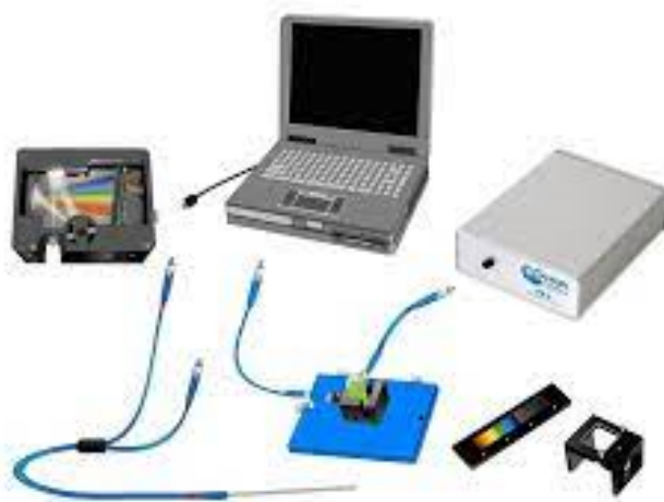
Рисунок 3.4 – Схема подключения USB2000
