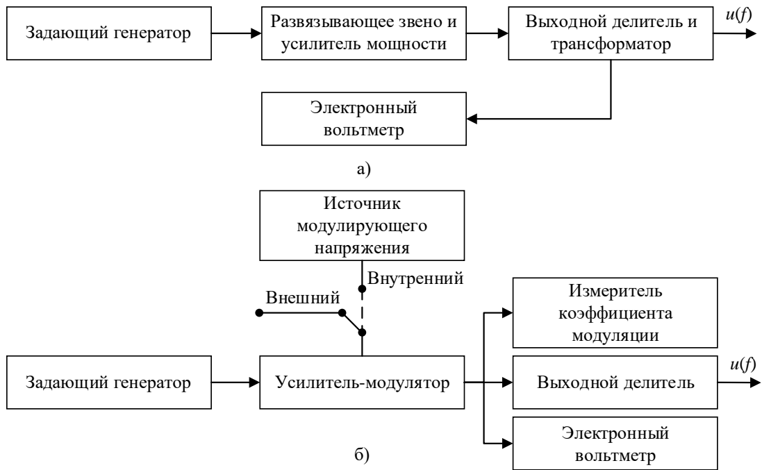
Рисунок 3.2 – Обобщенные структурные измерительные схемы: а) генератор сигнала; б) генератор стандартных сигналов
