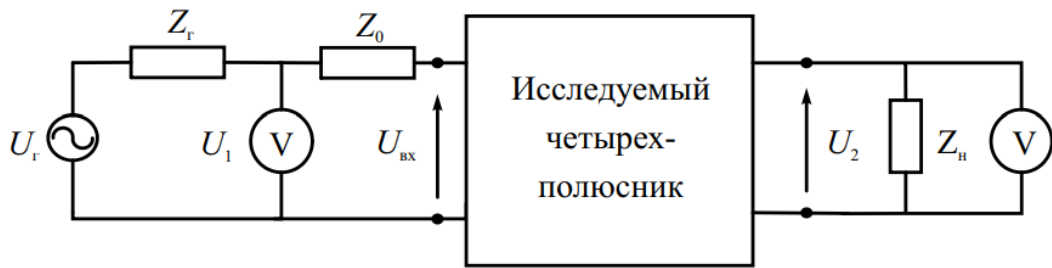
Рисунок 6.5 – Измерение АЧХ четырехполюсника по точкам с помощью двух вольтметров
