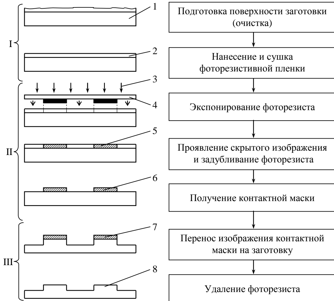
Рис. 11.1 — Схема процесса фотолитографии:
