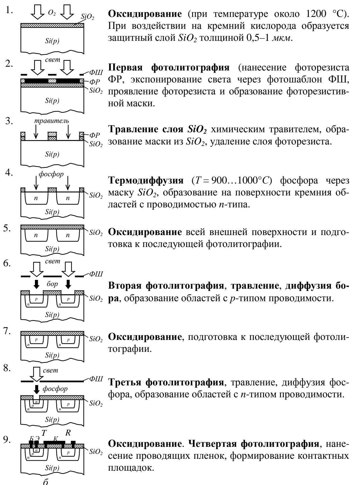
Рис. В.4 — Электрическая схема (а) и упрощенная профильно-технологическая схема (б) изготовления логического инвертора:
