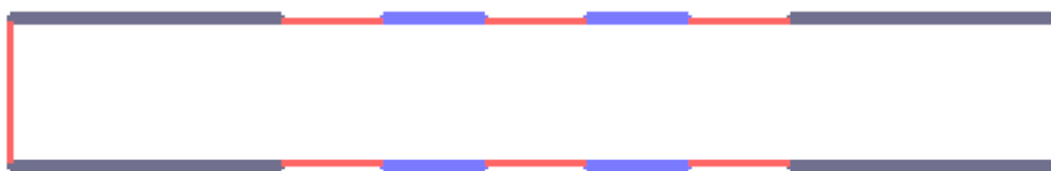
Рисунок 1.44 – TUSUR.EMC: структура с исполнением опорных проводников в виде боковых полигонов
