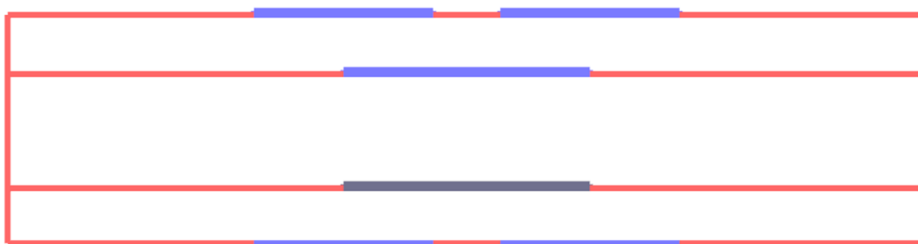
Рисунок 1.47 – TUSUR.EMC: структура с четырьмя проводящими слоями, один из которых опорный (без перемычек)
