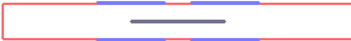
Рисунок 1.43 – TUSUR.EMC: структура с исполнением опорного проводника внутри диэлектрика в центре структуры
