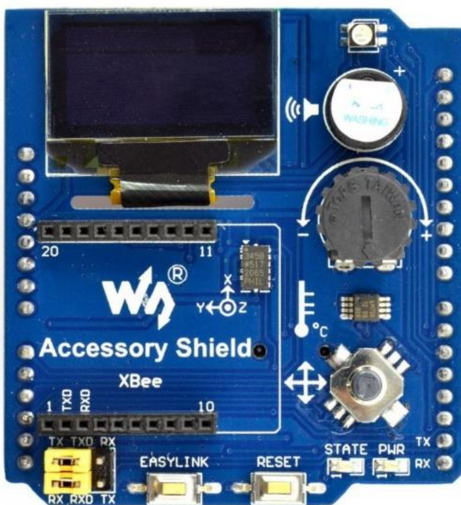
Рисунок 6.4 – OLED-дисплей в составе Accessory Shield
