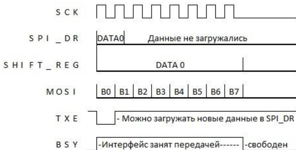
Рисунок 7.10 – Временная диаграмма работы SPI. Передача байта
