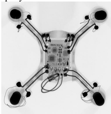
Рисунок 1.19 – Снимок напечатанного на Voxel8 квадрокоптера посредством томографии
