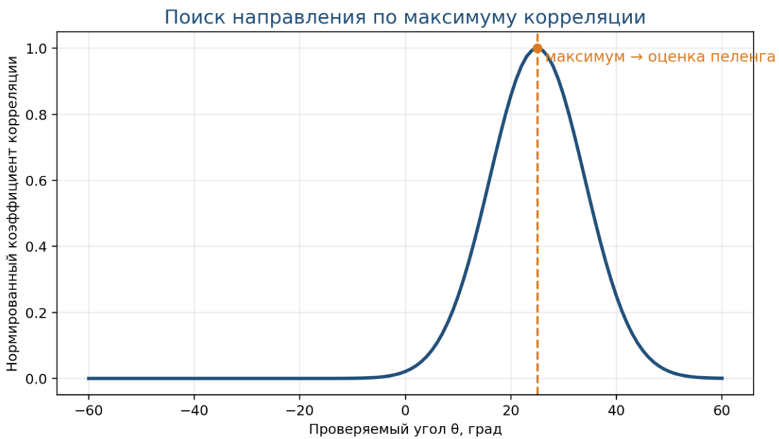
Рисунок 2.14 – Иллюстрация выбора направления по максимуму корреляции
