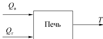
Рис. 3. Управление температурой печи по разным каналам
