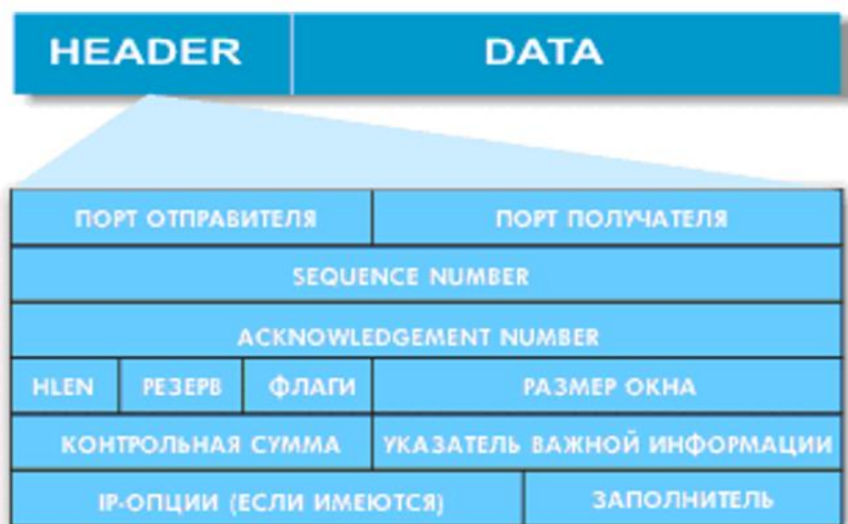
Рисунок 1.1 – Структура заголовка сегмента TCP
