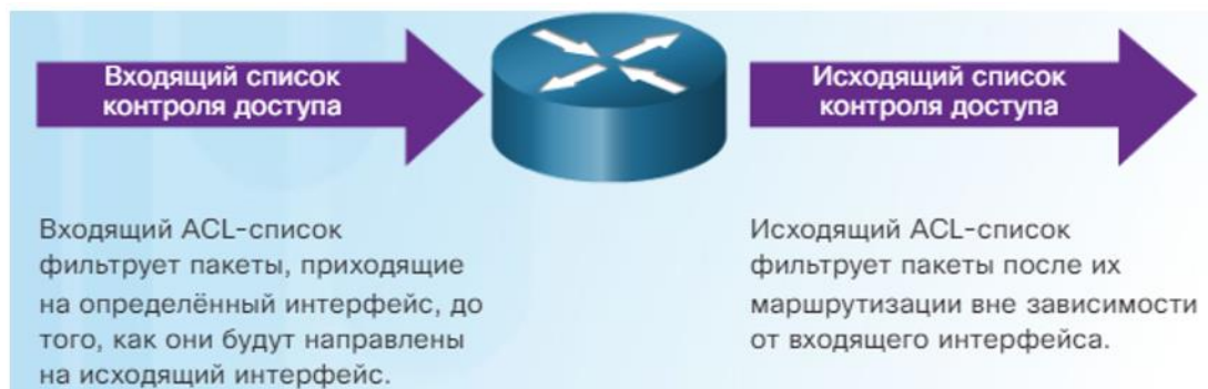
Рисунок 1.2 – На маршрутизаторах Cisco правила фильтрации можно создать для входящего и исходящего трафика
