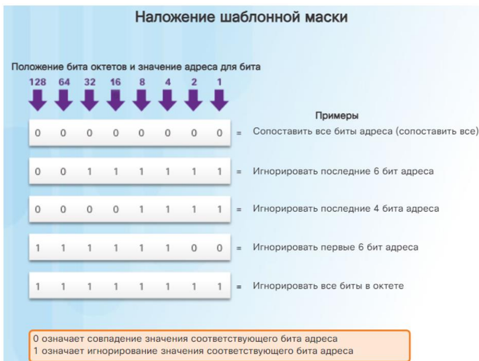
Рисунок 1.1 – Механизм действия шаблонной маски
