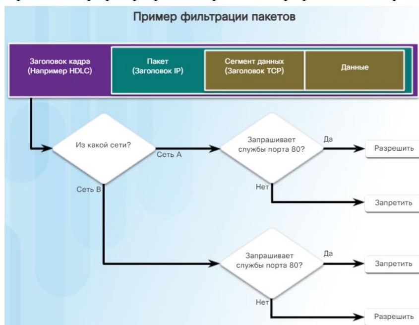
Рисунок 1.5 – Пример работы алгоритма проверки пакета на соответствие правилам списка
