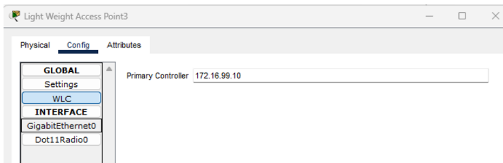
Рисунок 2.10 – Задание адреса WLC на точке доступа
