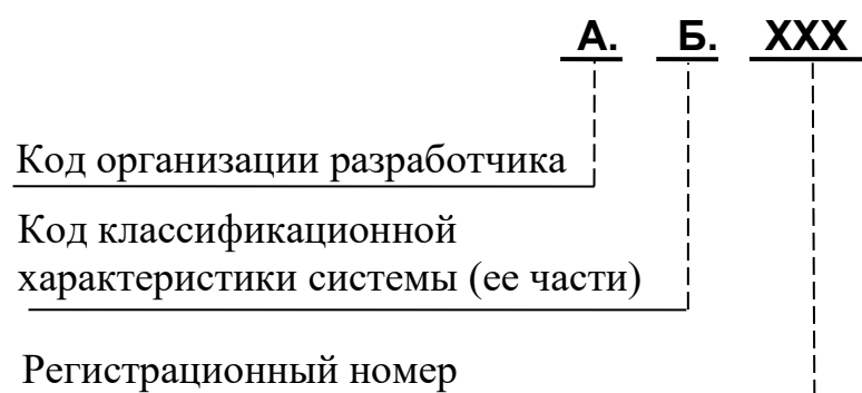
Рисунок 6.2 – Структура обозначения системы (части системы)
