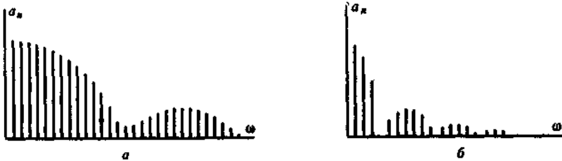
Рисунок 4.3 – Амплитудный спектр периодической последовательности прямоугольных видеоимпульсов: а – при большой скважности, б – при малой скважности
