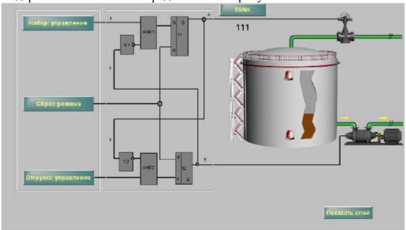
На мнемосхему следует добавлять объекты библиотеки со встроенной динамикой. Для управления динамикой графических объектов следует использовать окно редактирования псевдонимов, вызываемое контекстным меню объекта. Псевдонимам следует назначить имена ОРС сигналов, соответствующих состояниям объектов.
