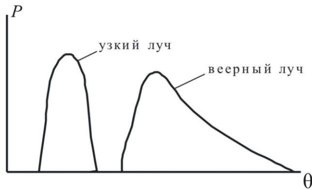
Рисунок 4. Диаграмма направленности антенны в вертикальной плоскости
