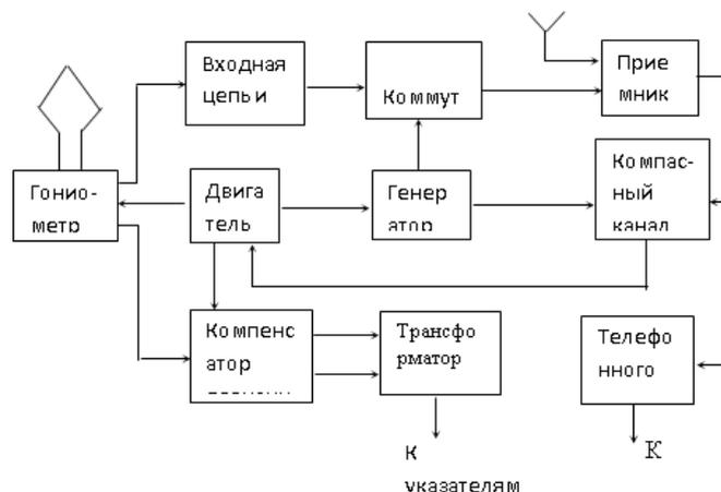
б) Структурная схема компаса в режиме «КОМПАС»
