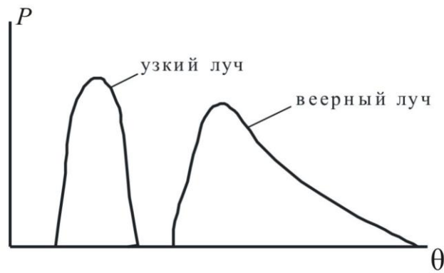
Рисунок 4. Диаграмма направленности антенны в вертикальной плоскости
