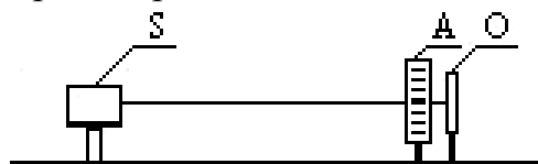
Рис. 1. Схема формирования волноводных структур. S-светодиод или лазер, А - амплитудная маска, О - фоторефрактивный образец.
