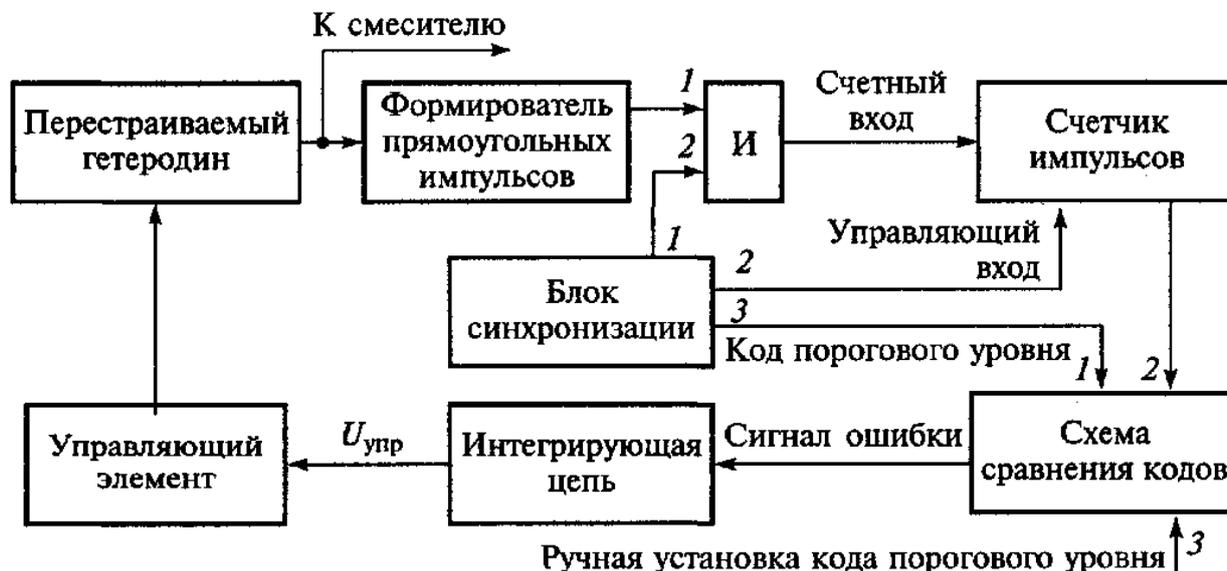
**Рисунок 11.9. Структурная схема системы ЦАПЧ с кварцевой стабилизацией времени счета**
