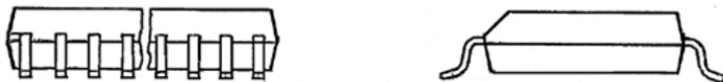
Рисунок 9.2 – Конструкция опрессованного корпуса микросхем типа SOLIC, подтип 43 по ГОСТ 17467-88 с числом выводов от 18 до 32
