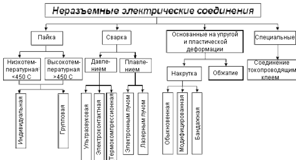
Рисунок 21.1 – Классификация методов выполнения неразъемных электрических соединений
