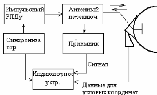
Рисунок 46.1 – Функциональная схема импульсной РЛС
