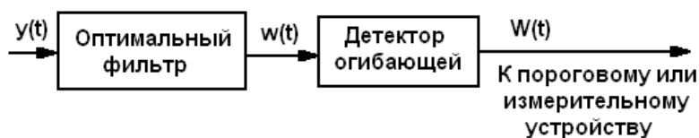
Рисунок 51.5 – Структурная схема одноканального фильтрового обнаружителя для когерентных сигналов с неизвестным запаздыванием
