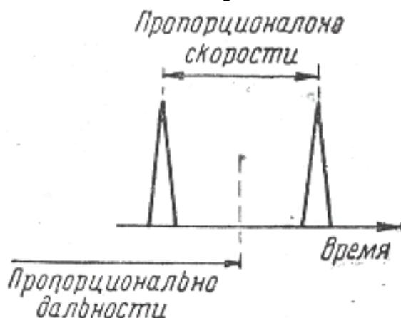
Рисунок 5.8 – Типично обработанное отражение от движущейся цели (развёртка типа А)
