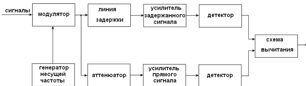
**Рисунок 4.6 – Упрощенная блок-схема компенсирующего устройства со сравнением сигналов по огибающей**
