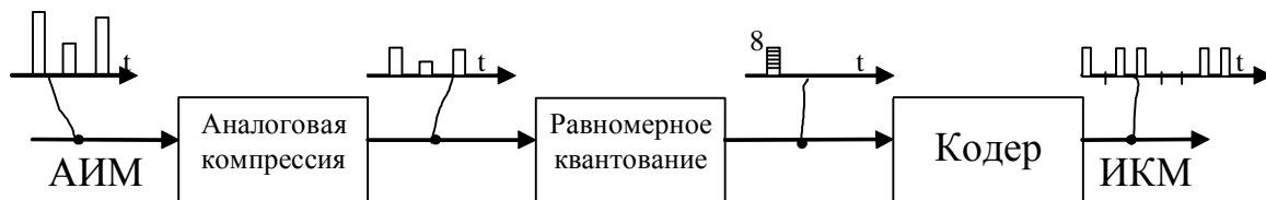
Рисунок 4.14 – Принцип аналогового компандирования
