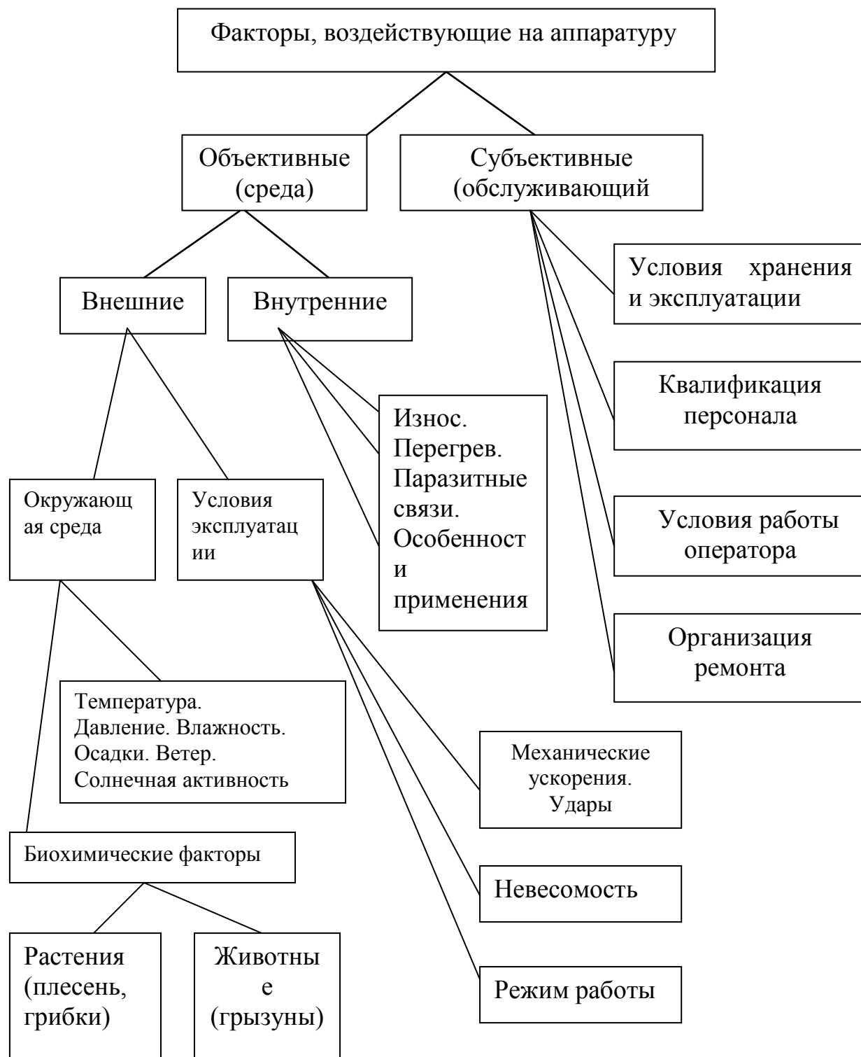
Рис. 18 - Схема связи дестабилизирующих факторов, воздействующих на РЭА
