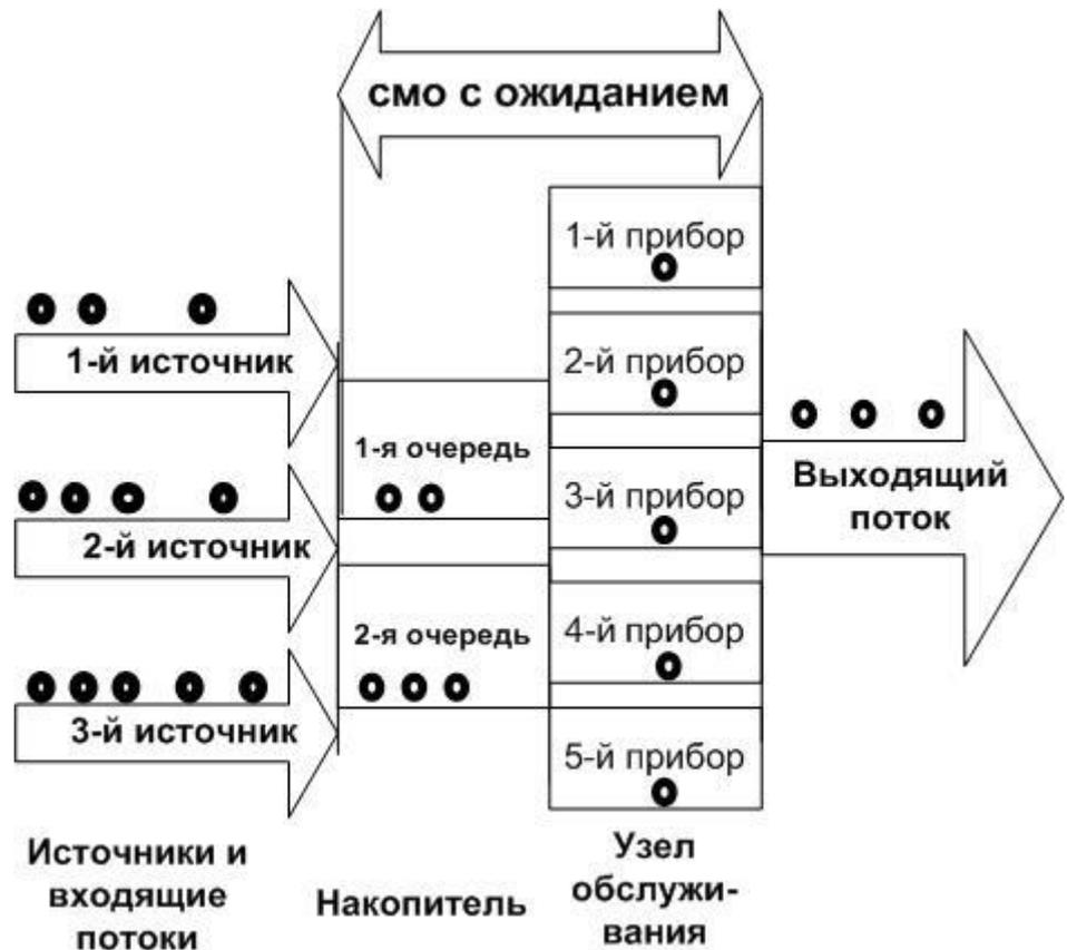
Рисунок 1.2- Структурная схема пятиканальной СМО с ожиданием с двумя очередями и с тремя входящими потоками [12 ]
