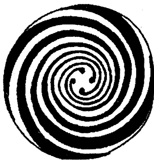
Рисунок 5.17 – Пример выполнения четырехзаходной логарифмической спиральной антенны
