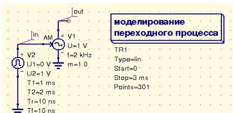
Рис.7. Схема для исследования временных характеристик амплитудно-модулированных сигналов
