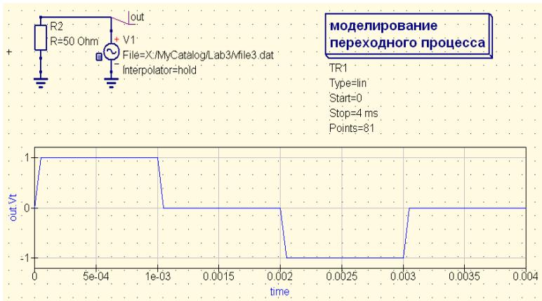
Рис.1. Схема для исследования временных характеристик сигналов произвольной формы.
