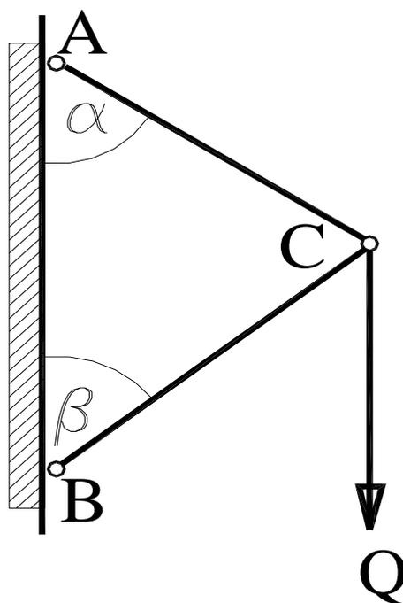
При действии нагрузки  $Q$  стержень  $AC$  растягивается, стержень  $BC$  сжимается. Найти соотношение сечений стержней, при котором относительное укорочение одного и относительное удлинение другого стержня будут одинаковыми. Материалы стержней одинаковы.
