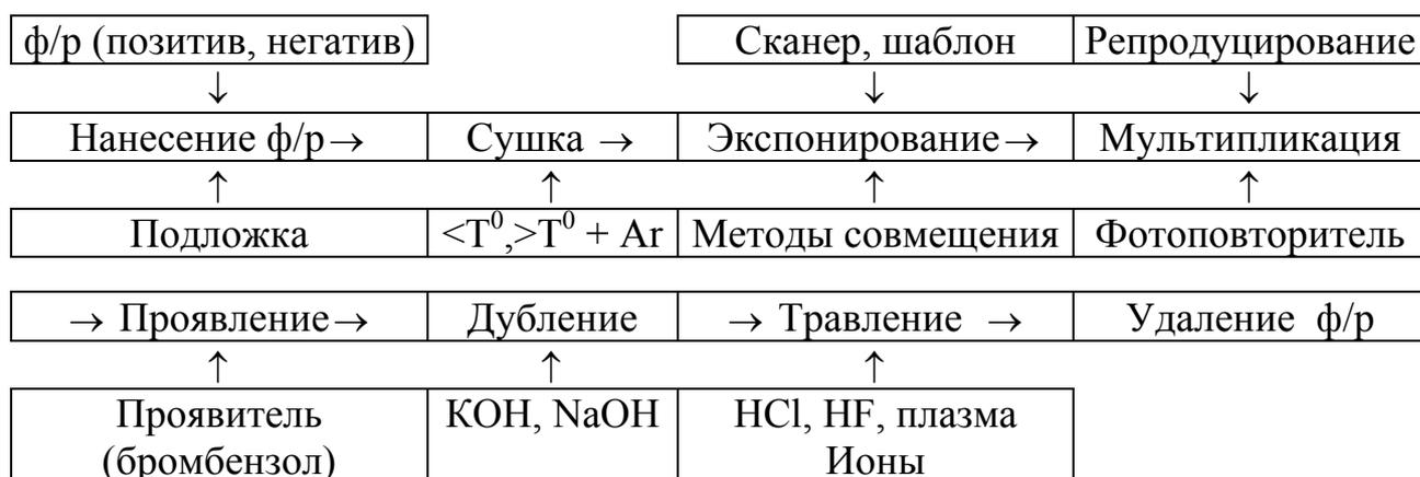
Рисунок 4.16 - Основные этапы типового литографического процесса
