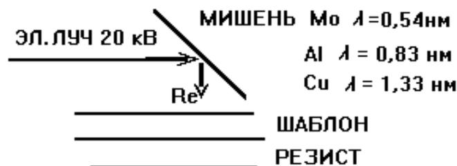
Рисунок 4.23 - Схема реализации рентгенолитографии
