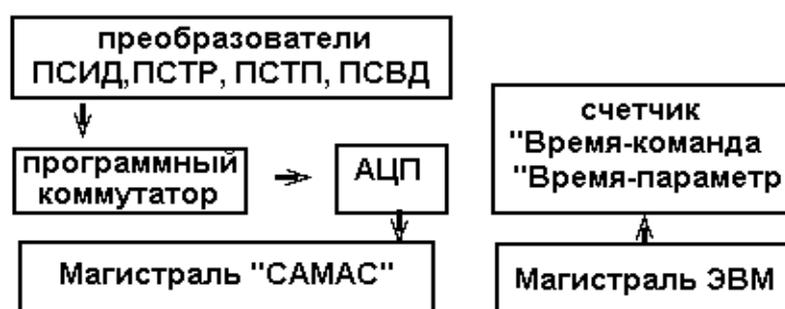
Рисунок 5.27 – Схема подключения датчиков к системе «КАМАК»
