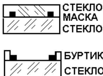
Рисунок 4.19 - Конструкция фотошаблона
