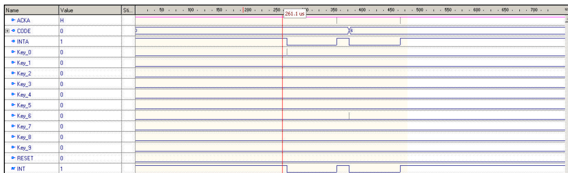
Рисунок 12 – Временная диаграмма «keyboard.awf» работы клавиатурного модуля
