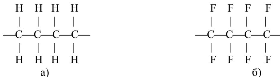
Рисунок 3.9 - Структурная схема неполярных полимеров: полиэтилена (а) и фторопласта-4 (тефлона) (б)
