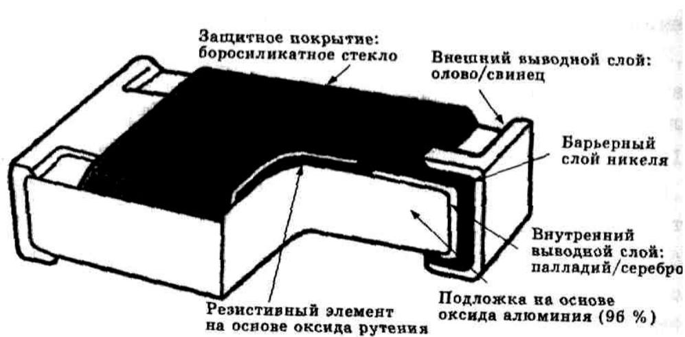
Рисунок 2.16. Типовая конструкция прямоугольного толстопленочного чип-резистора.
