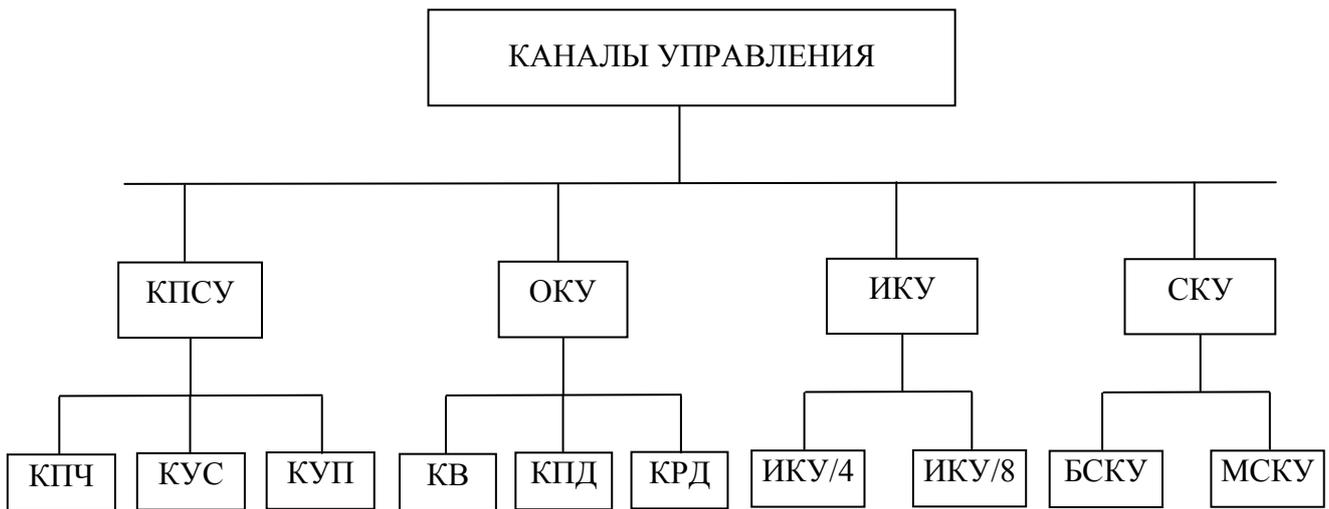
Рисунок 1 – Виды логических каналов управления в стандарте GSM
