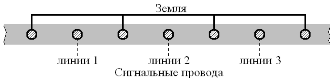
Рис. 2. Линии связи в плоском кабеле в устройствах повышенного быстродействия
