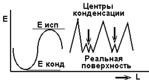
Рисунок 2.1– Потенциальная диаграмма и фрагмент реальной поверхности
