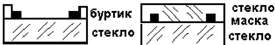
Рисунок 4.9 – Конструкция фотошаблона
