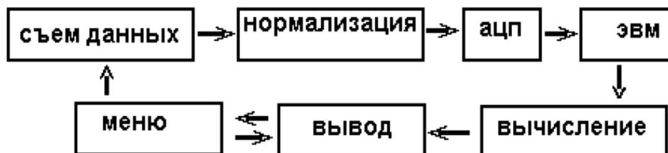
Рисунок 5.11 – Блок схема обработки данных с применением ЭВМ
