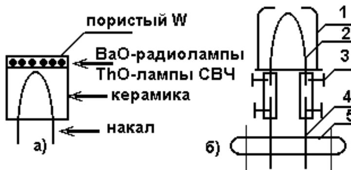
Рисунок 4.1 – Схема оксидного (а) и прямо накаленного (б) катода: 1 – экран; 2 – катод; 3 – винтовое крепление; 4 – токоввод; 5 – изолятор.
