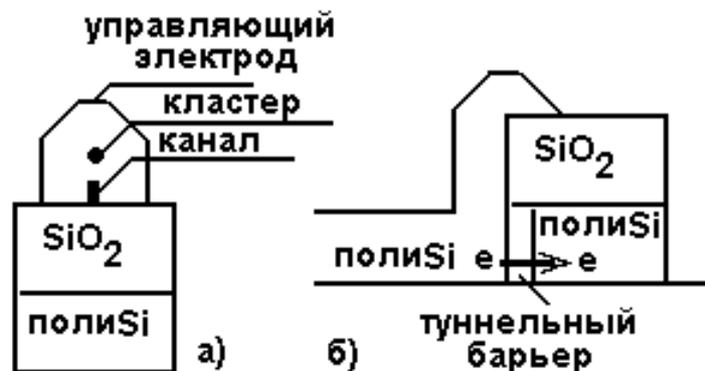
Рисунок 4.17 - а) схема формирования одноэлектронного устройства памяти, б) схема формирования одноэлектронного транзистора.
