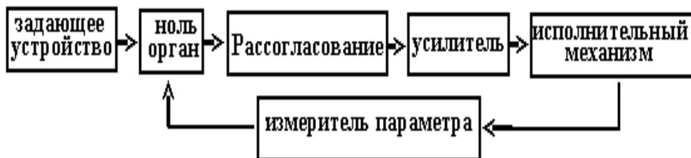
Рисунок 5.13 – Общая схема регулирования технологического процесса
