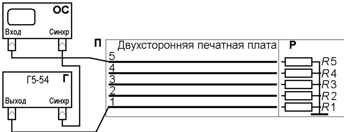
Рис.5. Схема экспериментальной установки: Г – генератор импульсов Г-54; ОС – осциллограф С1-65; Р – разъем; П – переключатель на 5 положений
